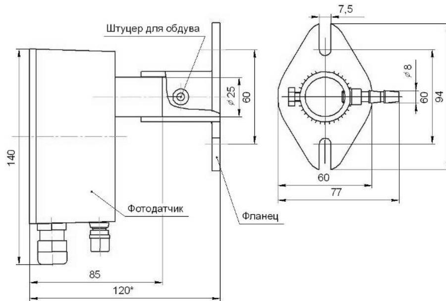
Рис.15. Конструкция фотодатчика ФДА.
