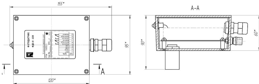
Рис.13. Конструкция фотодатчика сигнализирующего ФДС-03
