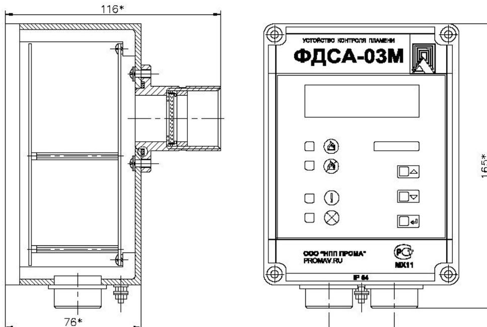
Рис. 18. Устройство контроля пламени ФДСА-03М
