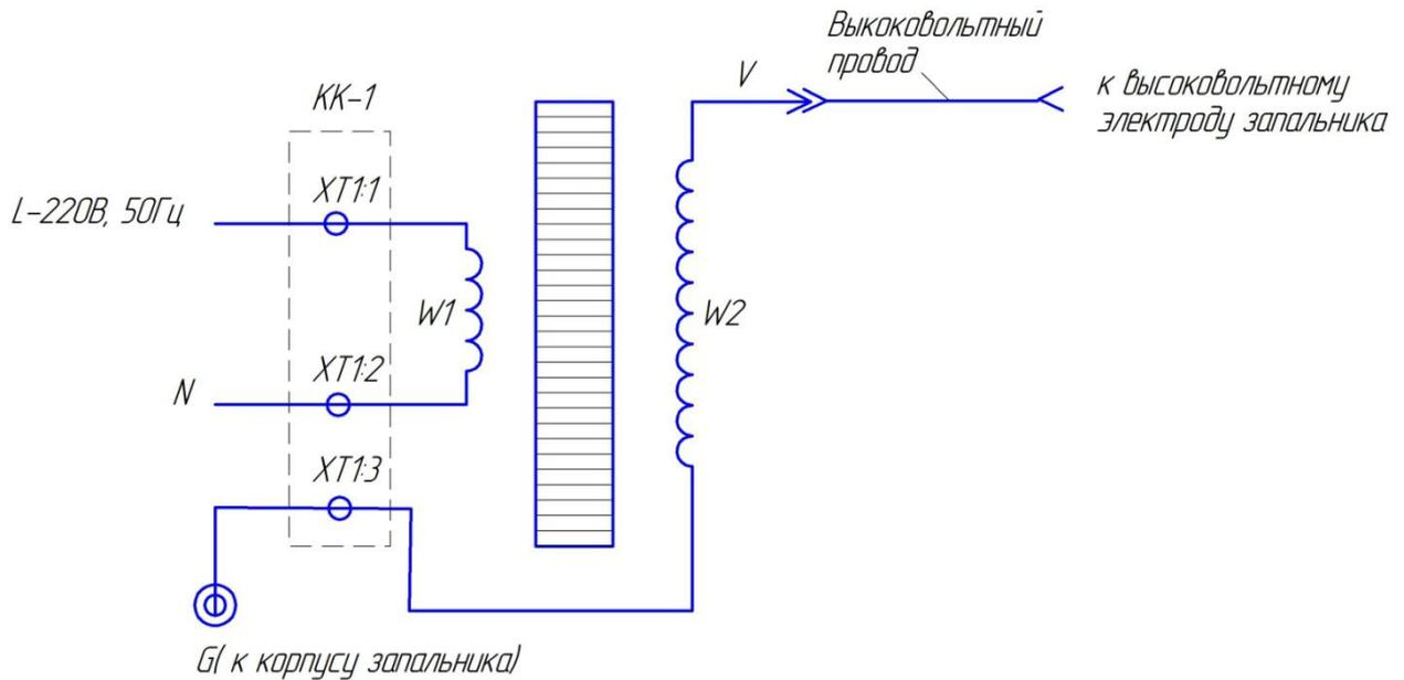
Рис 6.1. Электрическая схема ИВН-ТР.
