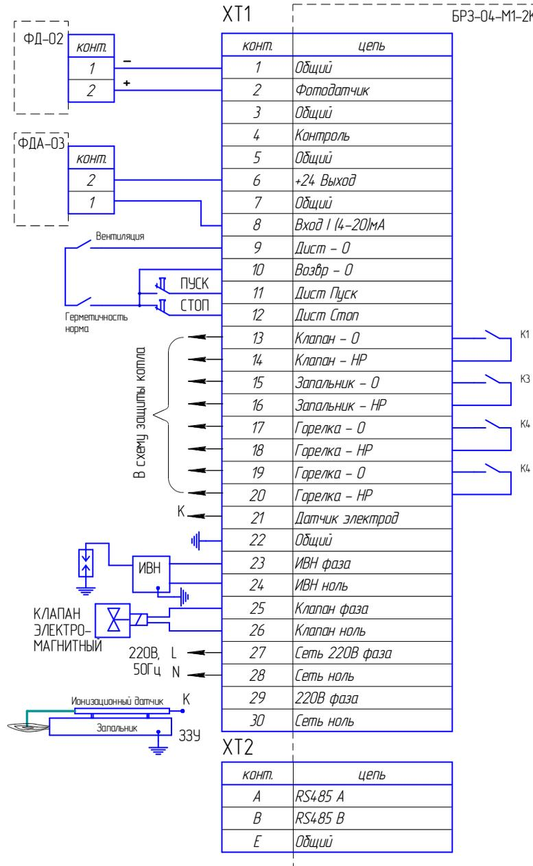
Рис.24. Схема внешних подключений блока розжига запальника БР3-04-М1-2К.
