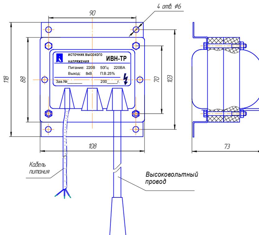
Рис. 6. Источник высокого напряжения ИВН-ТР. Габаритный чертеж.
