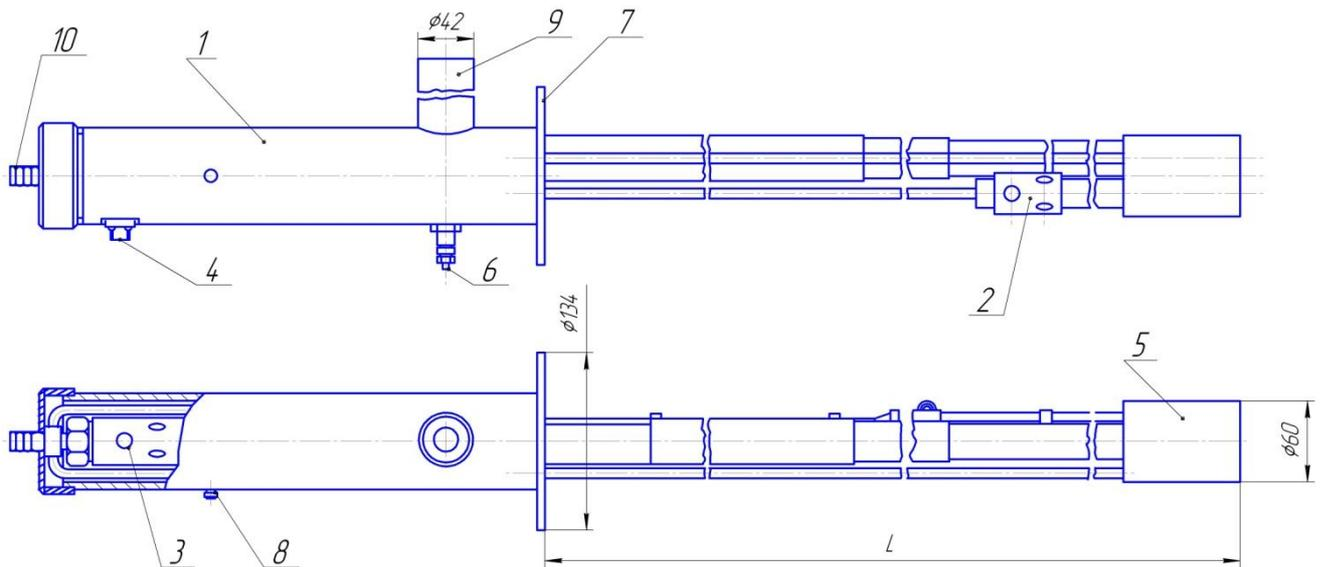
Рис. 4. Общий вид запальной горелки ЗГИ 1/5Б.
