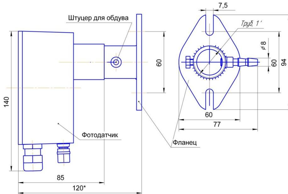
Рис. 10. Фотодатчик ФД-05ГМ. Габаритный чертеж и схема электрическая.
