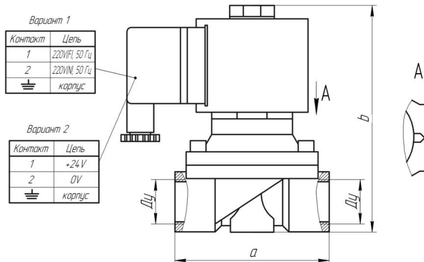
Рис. 8. Клапан электромагнитный КЭГ-15.
