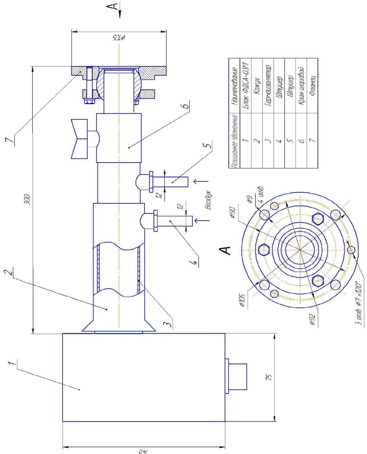
Рис. 19. Конструкция ФДСА-03М с юстировочным монтажным узлом.
